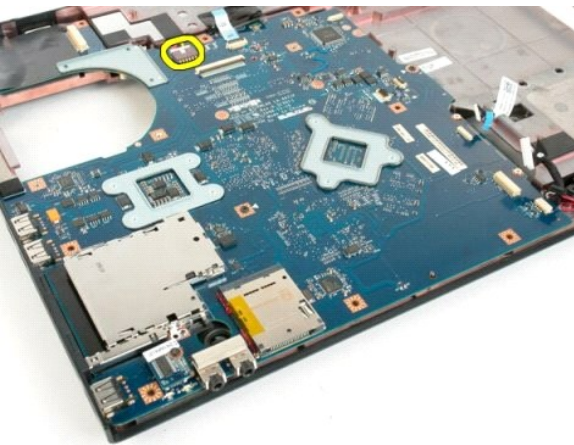
15. 卸下來將主機板固定至電腦機箱的三顆螺絲。
